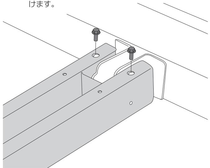
**31** スロープバーを上げ、ヒンジのスロープ用ボルトが干渉しないか確認し、干渉しないように調整します。
