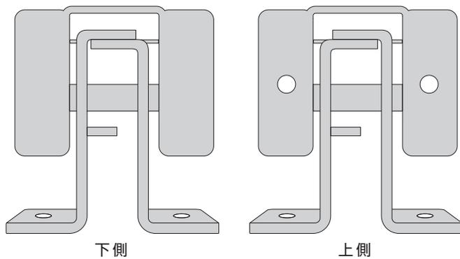
**28** ヒンジをスロープ用ボルトで、土台4箇所に取り付けます。
