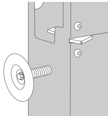
**30** スロープバーをヒンジに差し込み、スロープ用ボルトで仮留めします。スロープバー中央も同様に取り付けます。
