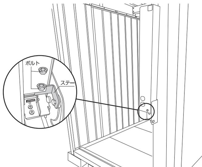
**26** 土台左右2箇所、合計4本のボルトを取り外します。
