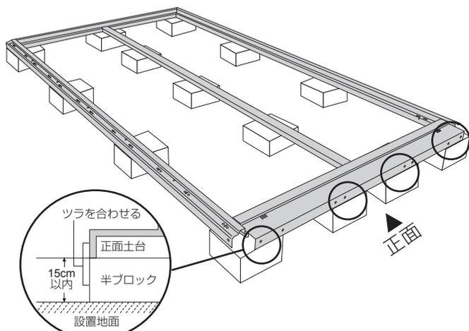
土台正面と半ブロックの断面はできるだけまっすぐにツラを合わせてください。また、土台から設置地面までの高さは15cmまでに抑えてください。
